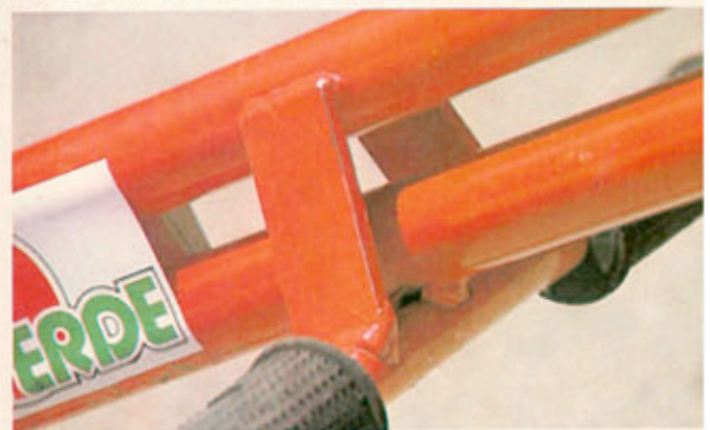
Las soldaduras presentan un aspecto muy uniforme.
