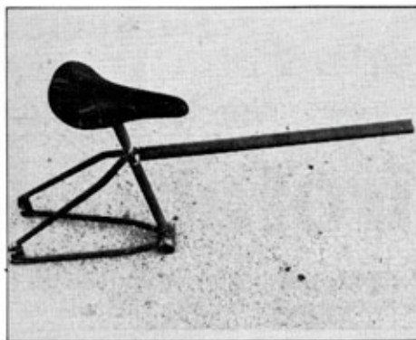
Al soldar el tubo superior conviene actuar con sumo cuidado si queremos obtener un chasis recto.
