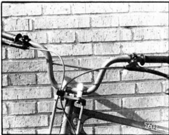
El manillar tiene las puntas muy cerradas y se caracteriza por su singular estrechez (660 mm.)
