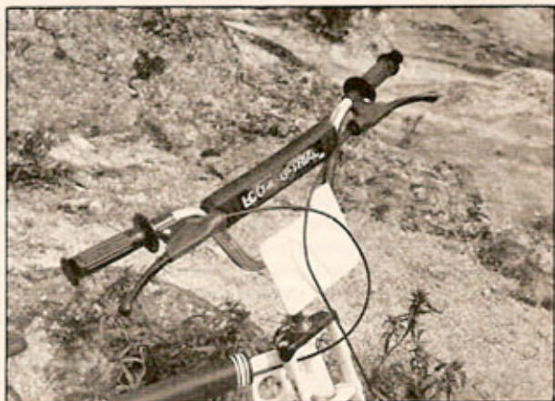
El manillar es de tipo Trial, con refuerzo central y protector de goma espuma.
