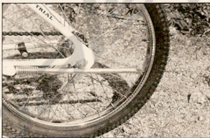
La pata de cabra sobresale en exceso de la parte trasera del cuadro, rozando a veces con las piedras.
