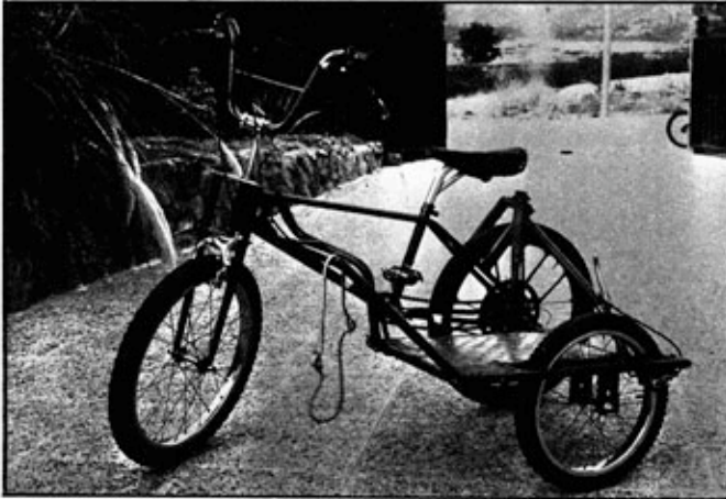
En la foto se puede ver una máquina para la práctica del side-bicitrial. En este caso se trata de una Rabasa-Derbi, con el atalaje atornillado al chasis.
