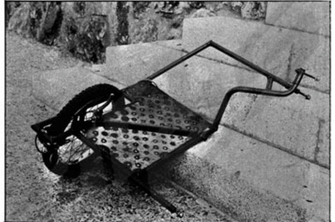
El side separado de la bicicleta. El tubo delantero de sujeción está curvado para que el pie del piloto pueda pasar sin dificultad.
