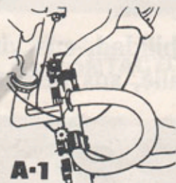
REF. FELINO A. Conjunto para-bicicletas completo con barras rectangulares 35 x 15 x 115 universales con pata de hierro. Dos bicicletas iguales. No es necesario desmontar ninguna rueda.
