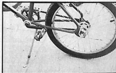
Las bielas de los pedales son algo muy especial de estas Montesita, ya que están construidas de una sola pieza, eliminando los posibles juegos de estos elementos con el uso.
